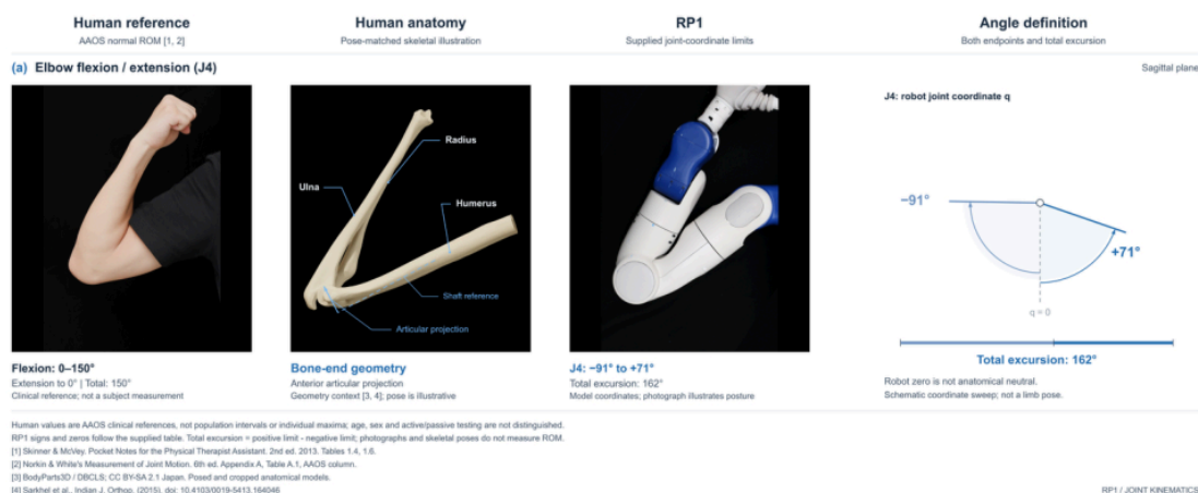
图 1.11. 人体与 RP1 的肘屈曲对比。人体参考：[42]；RP1 限位与照片：[21]。
