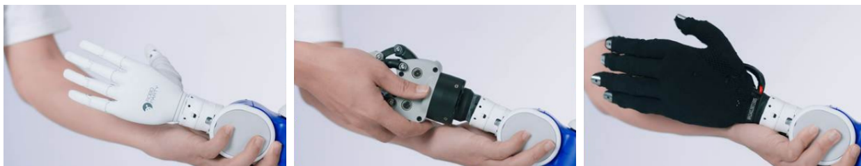
图 1.26. RP1 腕部接口与三种可互换末端执行器。来源：RoboParty [21]。
