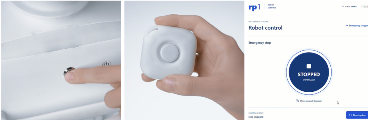
图 2.6. RP1 急停输入与示例软件界面。来源：RoboParty [21]。
