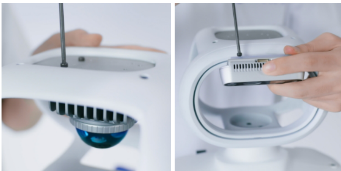
图 1.27. 拆卸 RP1 头部感知模块。来源：RoboParty [21]。
